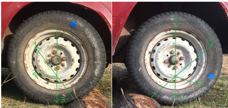
Рис.1. Проекция сил, действующих на колесо при передвижении через искусственную неровность: 1 – сила реакции препятствия, 2 – направление перемещения колеса относительно колесной арки, 3 – сила тяжести
