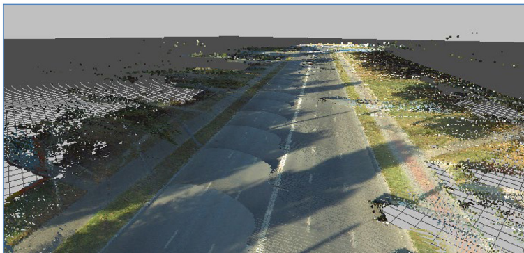
Рис. 3. Вид рельефа, выделенного из облака точек, в программе 3D СКАН
