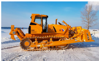
Рис. 2. Бульдозер на тракторном гусеничном шасси с поворотным отвалом
