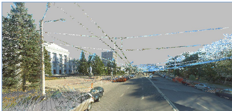
Рис. 1. Вид облака точек в программе 3D СКАН
