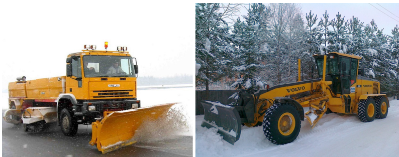
Рис. 1. Виды техники для уборки снега: плужный очиститель на колесном ходу; автогрейдер на колесном ходу
