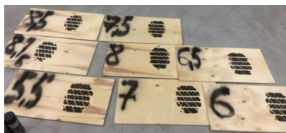
Рис. 2. Визуализация замеров пятна контакта при различных давлениях воздуха в шине
