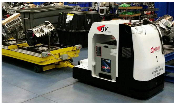
Рис. 2. Автоматически управляемая тележка AGV
