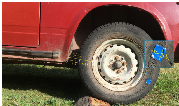
Рис. 2. Расчёт отклонений колеса автомобиля
