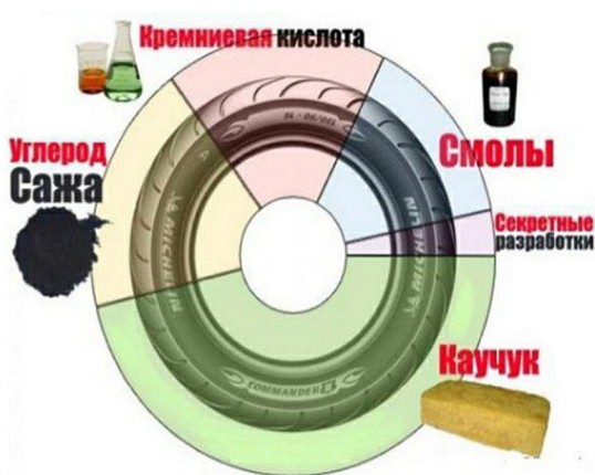
Рис. 1. Состав автомобильной шины
